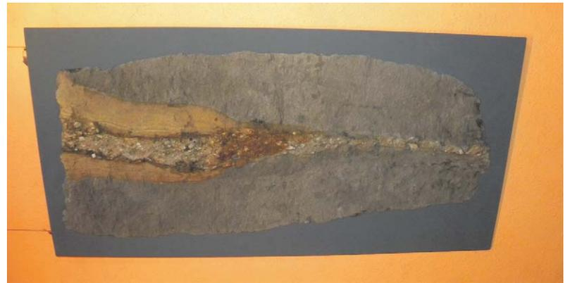
Zeugnis aus dem Dauerfrostboden: Lackprofil eines Eiskeils, Tagebau Zwenkau 1995
